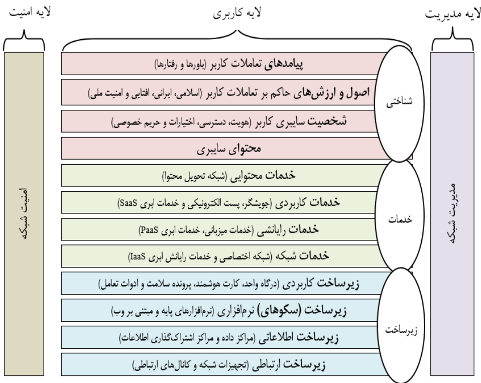
شکل ۶: مدل توسعه یافته در استاندارد ITU-T X.805 بر اساس لایه ای افقی-عمودی
